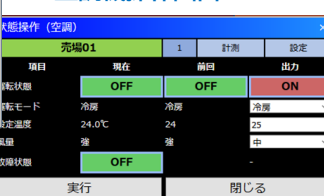
■空調機操作画面
