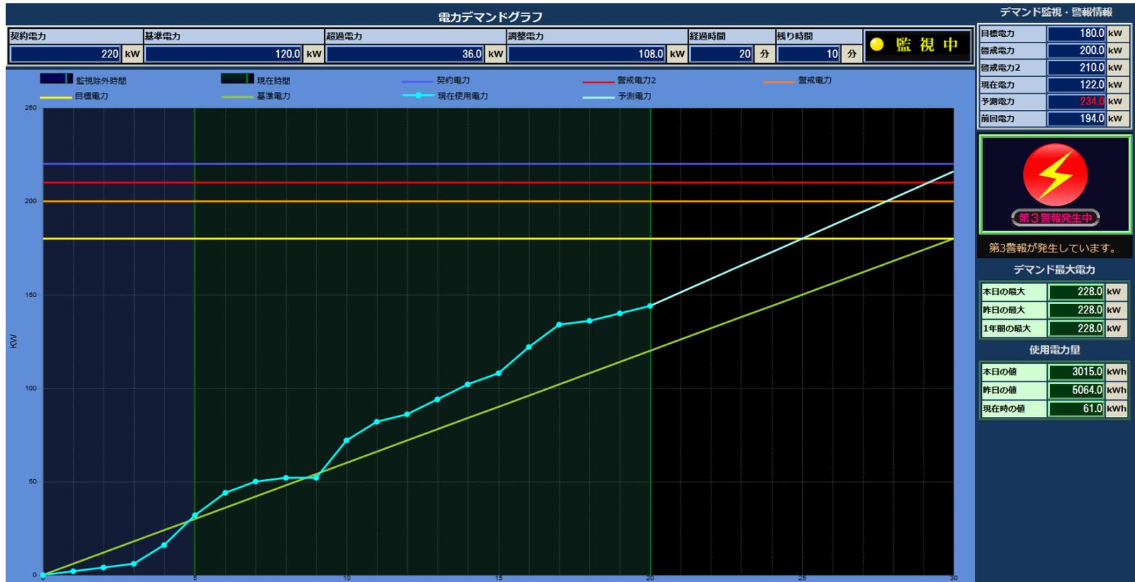
毎正時から30分間ごとの使用電力量について、時間を追って1分単位で計測して折線グラフとして表示します（水色線）。また、スタートから現在時点までの使用電力の状況から、30分時点での使用電力（30分デマンド値）がどうなるかを予測して表示します（水色線の延長の白色線）。
