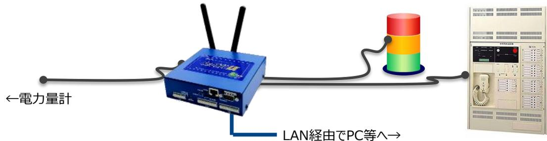
**DO出力による警報機器の制御** (Modbus,BACnet通信I/F機器への制御も可能です。)
